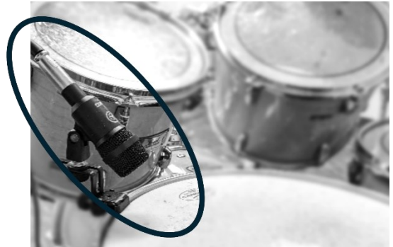
図1: スネアドラムの音を狙ったマイク
